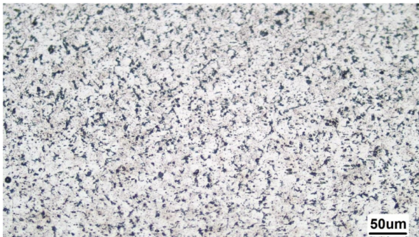
شکل 14- تصویر ریزساختار فلز جوش حاصل از فرایند جوشکاری SMAW توسط میکروسکوپ نوری.
